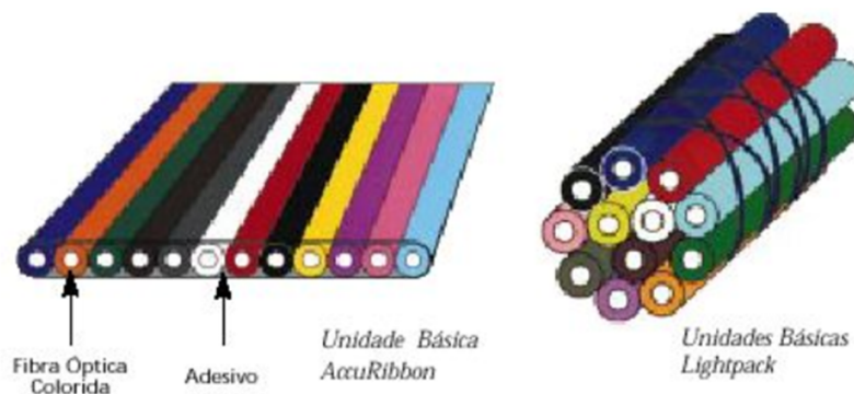
Figura 10: Construção Ribbon Fonte: Caetano (2011)
