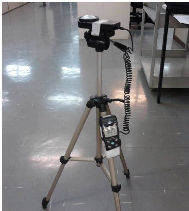
Figura 21 – Fotografia – tripé para suporte do luxímetro Fonte: Autoria própria
