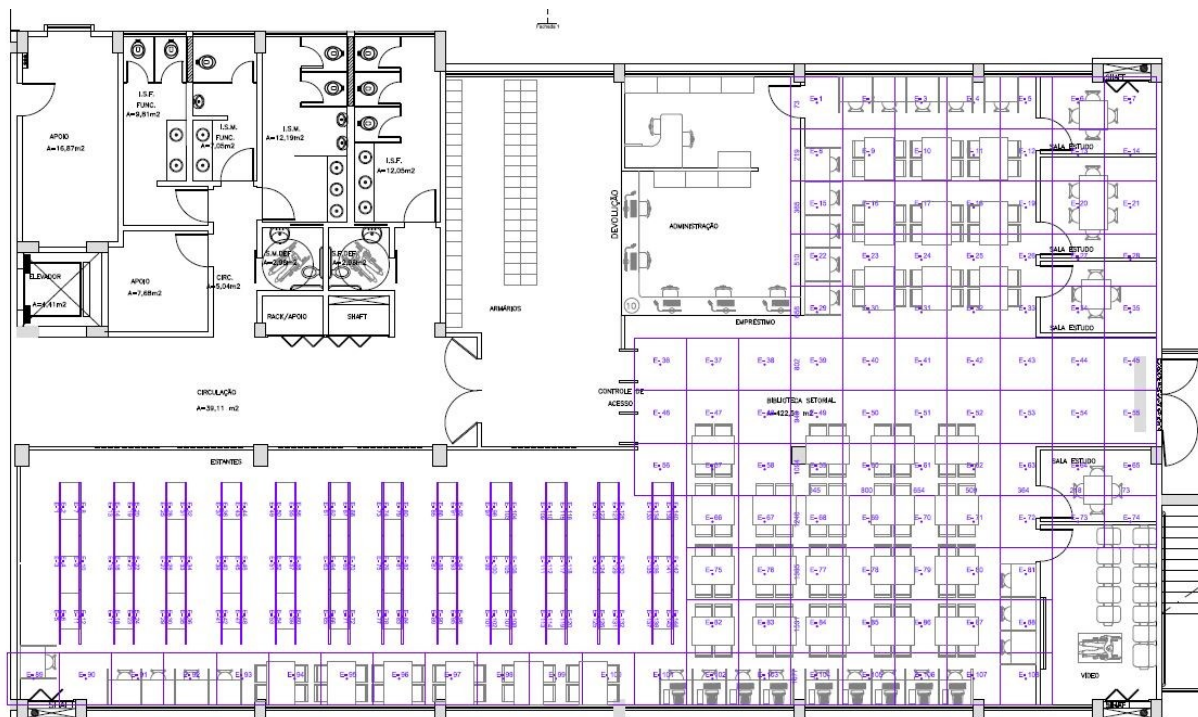
Planta com as malhas de medição da biblioteca de Curitiba - Ecoville.
