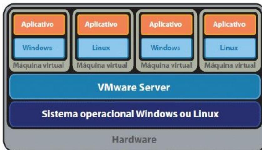
Figura 1: Modelo de Virtualização dependente de um Sistema Operacional
