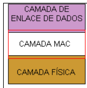
FIGURA 2 - LOCALIZAÇÃO DA CAMADA MAC DENTRO DO MODELO OSI DA ISO
