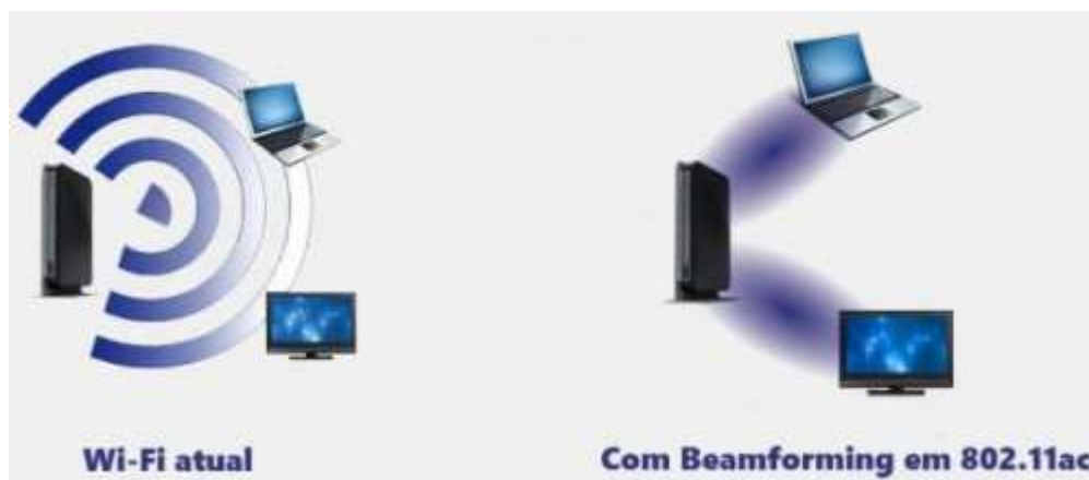
Figura 10: Comparativo sinal da rede sem fio sem e com Beamforming . Fonte: (PLAZA, 2014).
