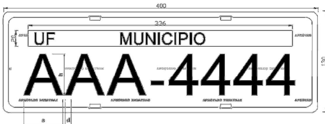
Figura 11 - Dimensões da placa de Automóvel
