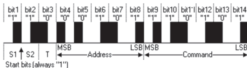
Figura 8: Protocolo RC5 - Transmissão do endereço 5h e comando 35h
