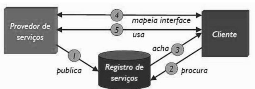
Figura 5 – Interação entre os elementos da arquitetura de Web Services Fonte: Lima (2012)
