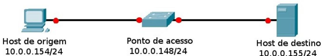
*Figura 4 - Estrutura da rede experimental*
