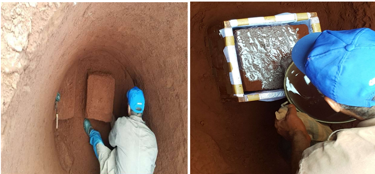
Figura 15: Entalhe da amostra do solo e proteção com parafina fundida.
