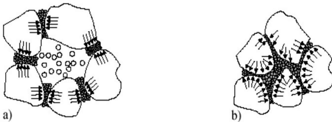
Figura 1: Estrutura do solo colapsível carregado sem inundação (a) e com inundação (b).
