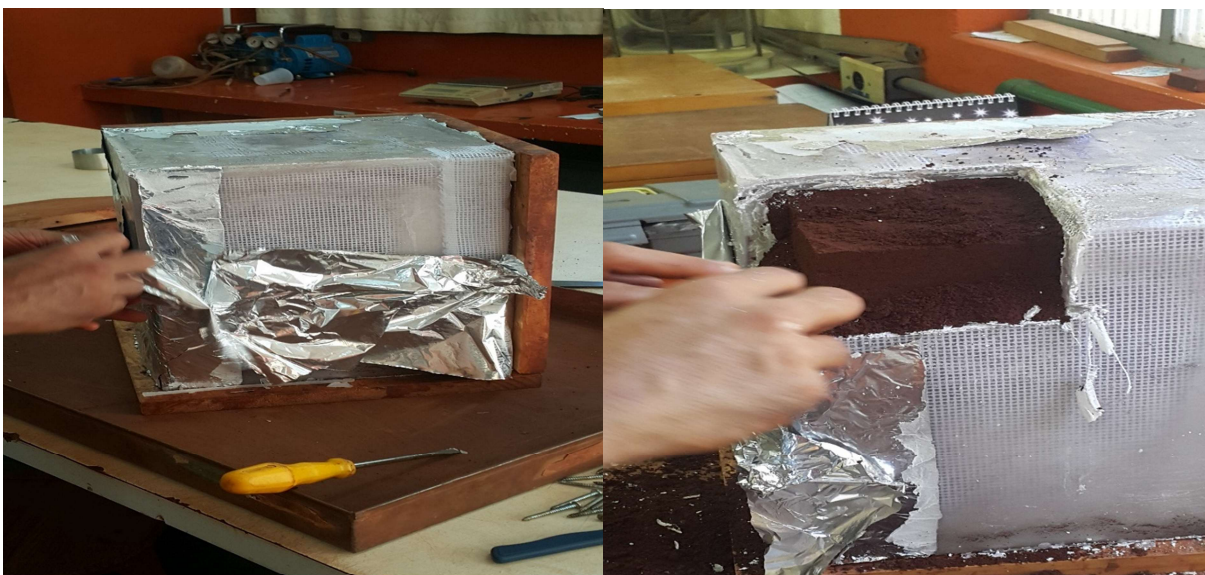
Figura 16: Bloco de solo indeformável e preparo para retirada da amostra.
