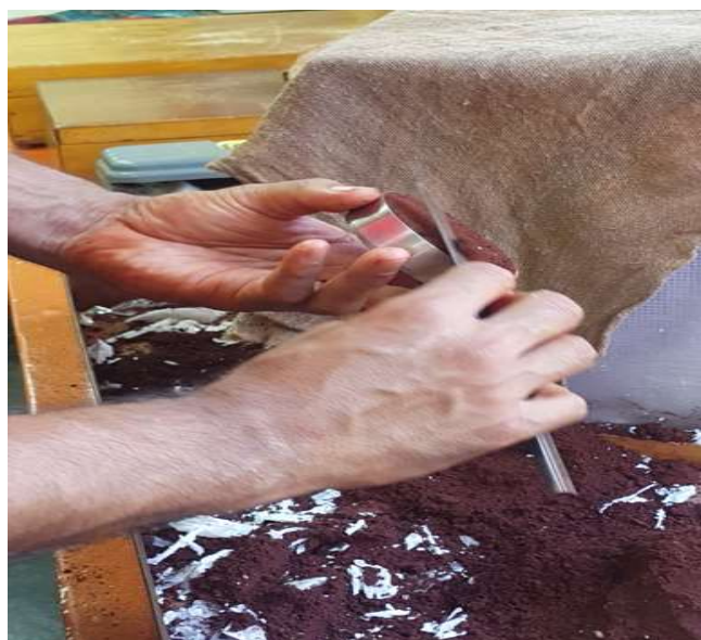
Figura 18: Entalhe final do topo e da base da amostra no anel de adensamento.
