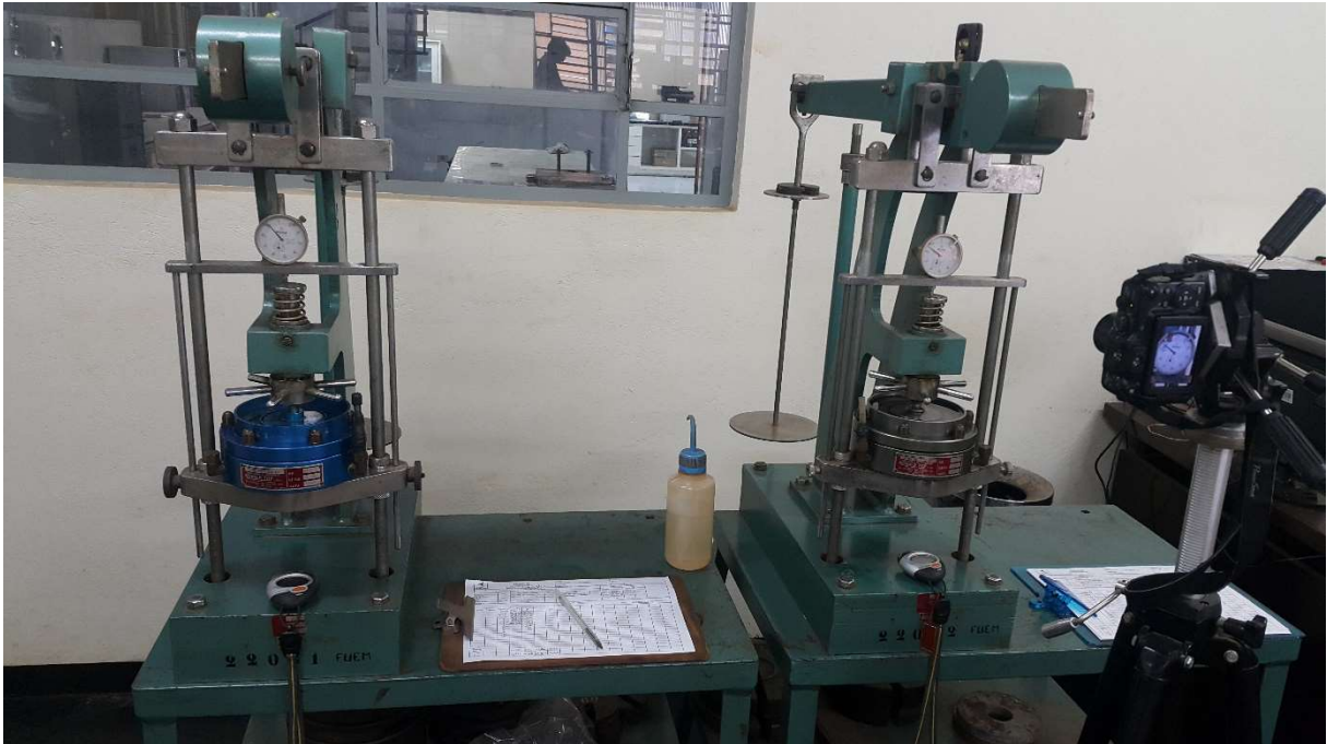
Figura 20: Ensaio de adensamento duplo, a esquerda o corpo de prova em estado natural de umidade e a direita o corpo de prova inundado.
