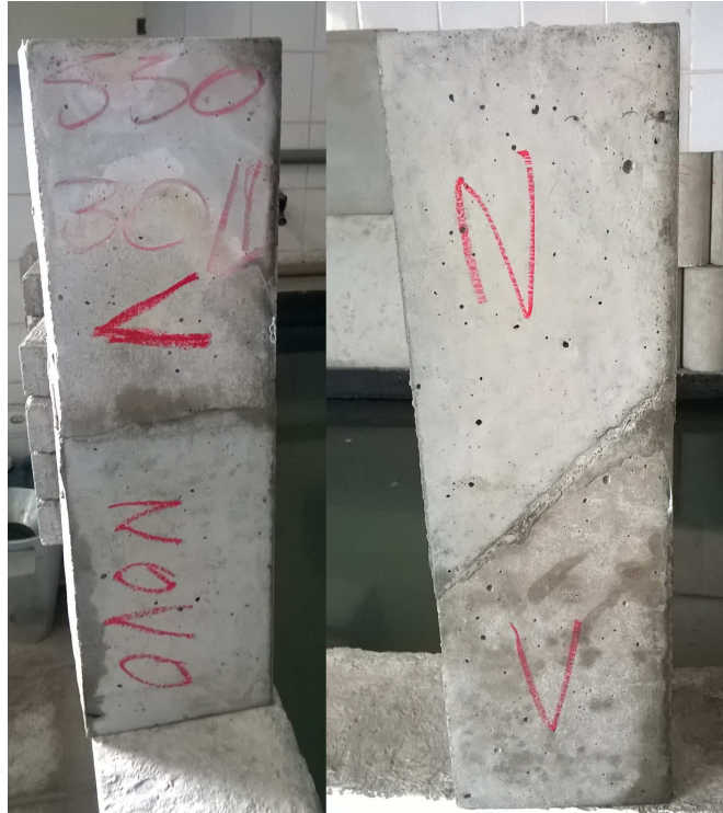
Figura 17 – Corpos de prova prismáticos após união “concreto velho/novo” Fonte: O autor
