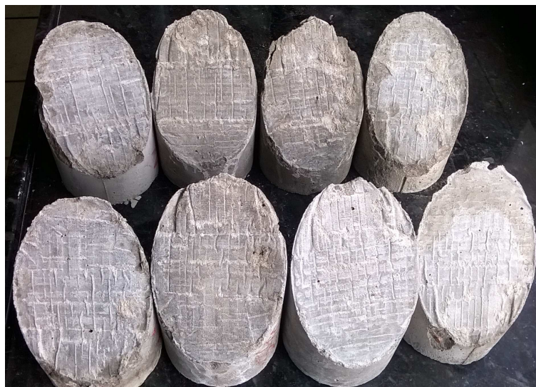
Figura 23 – Detalhe dos corpos de prova de junção 45° após rompimento Fonte: O autor.
