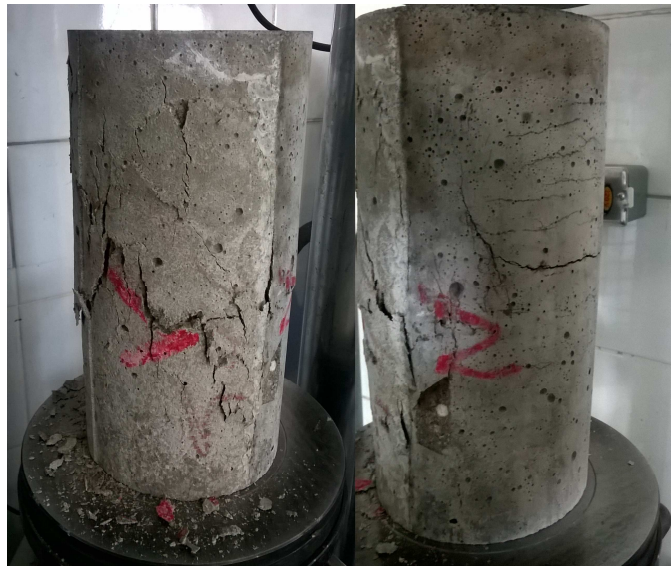
Figura 20 – Rompimento CP cilíndrico junção 90° “concreto velho/novo”
