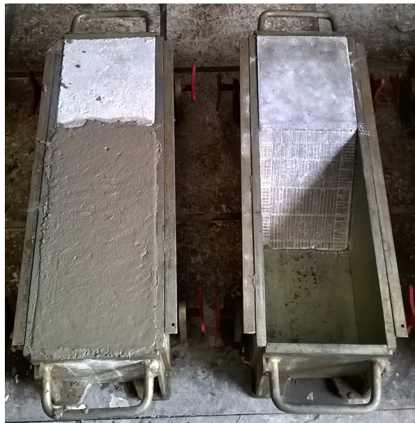
Figura 16 – Moldagem corpos de prova prismáticos – secção concreto novo Fonte: O autor
