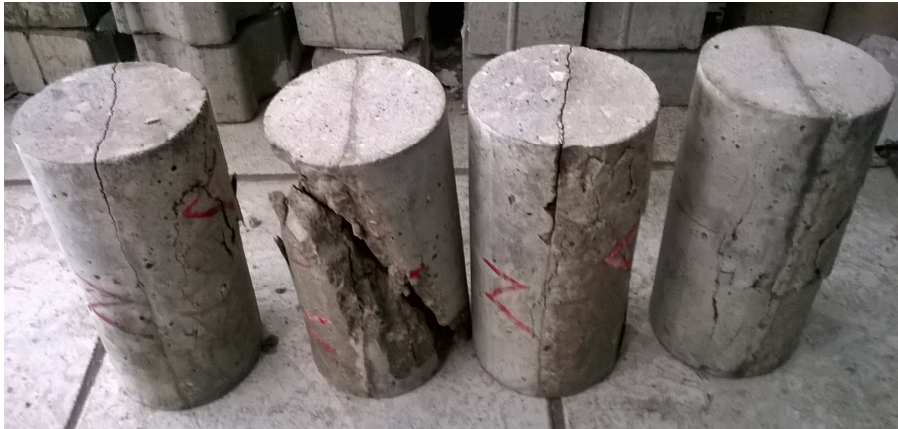
Figura 21 – Rompimento junção 90° “concreto velho/novo” dos 4 corpos de prova Fonte: O autor.
