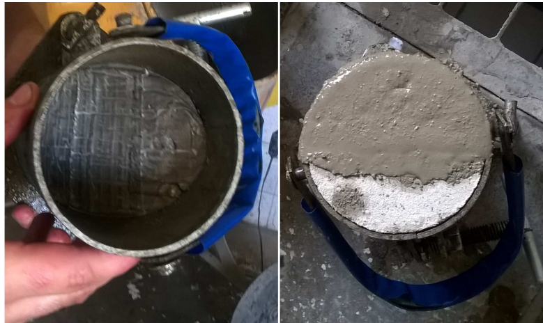
Figura 15 – Moldagem corpos de prova cilíndricos – secção concreto novo Fonte: O autor
