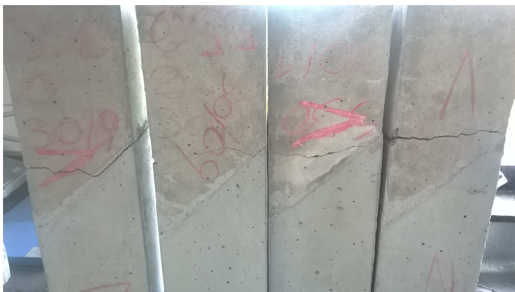
Figura 25 – Detalhe dos corpos de prova prismáticos e junção 45° após rompimento Fonte: O autor.
