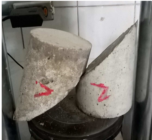
Figura 22 – Rompimento CP cilíndrico junção 45° “concreto velho/novo” Fonte: O autor.
