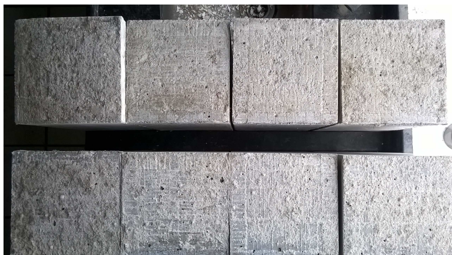
Figura 24 – Detalhe dos corpos de prova prismáticos de junção 90° após rompimento Fonte: O autor.
