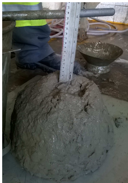
Figura 14 – Ensaio slump test no “concreto novo”
