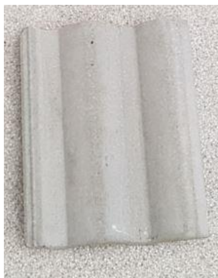
Figura 45 – Concreto ondulada Fonte: autor
