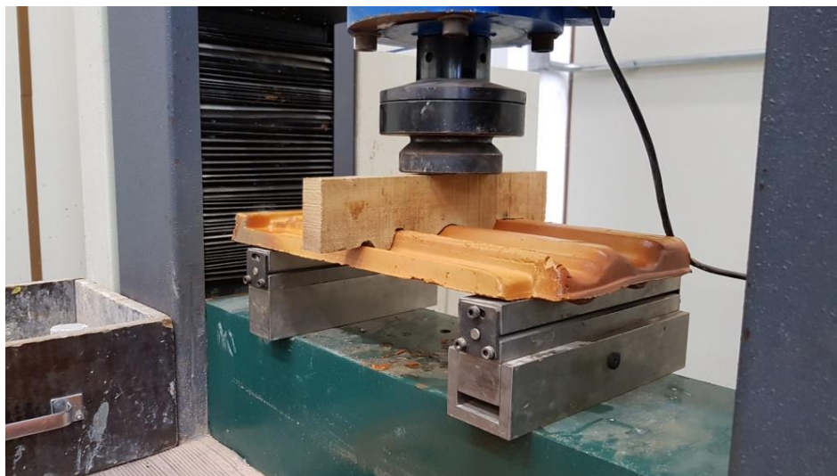
Figura 57 – Ensaio de força - flexão/deformação Fonte: autor
