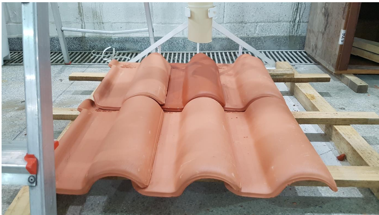
Figura 49 – Detalhe (telha úmida pronta para receber impacto) Fonte: autor
