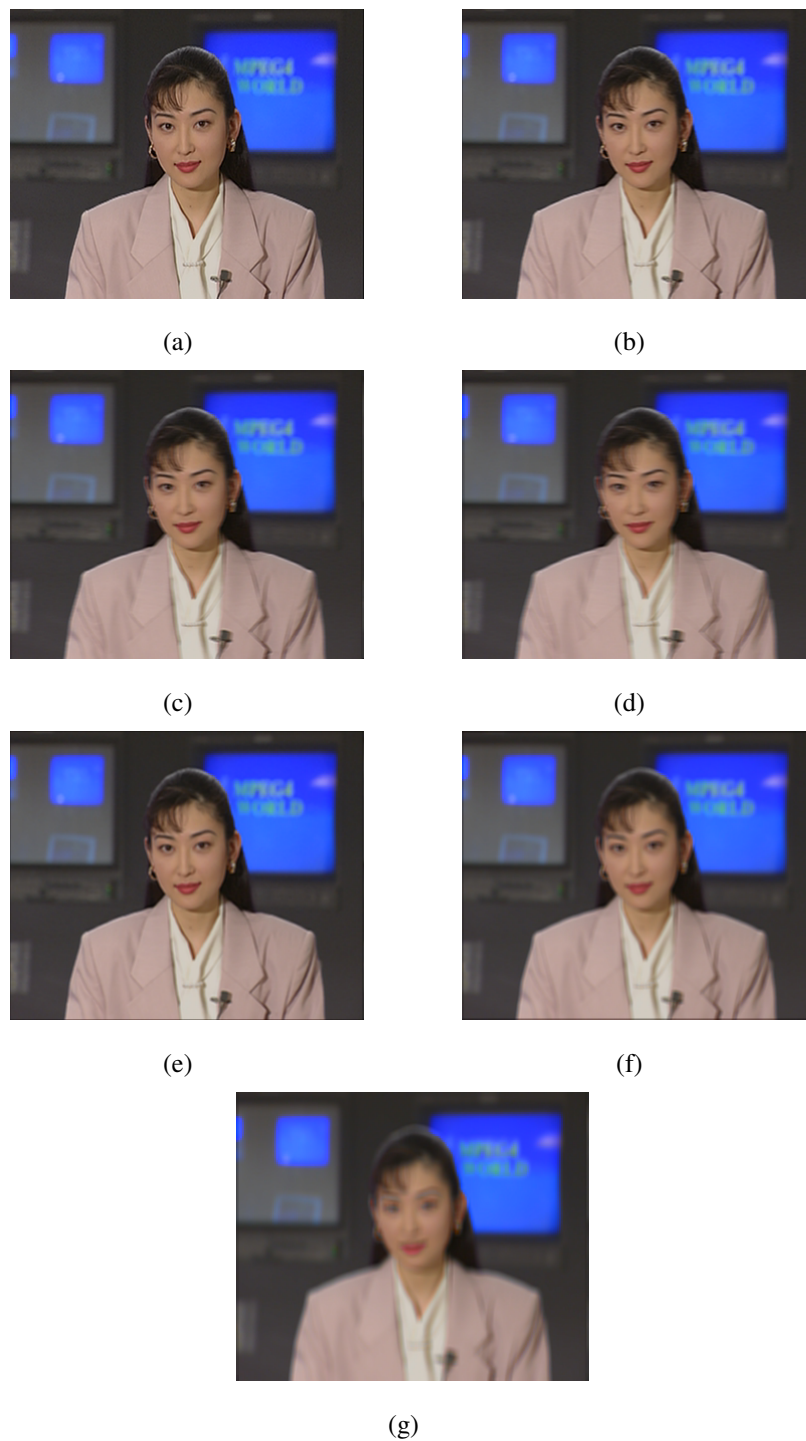
Figura 37: Quadros com borramento: (a) Original, (b) com máscara linear 3, (c) com máscara linear 5, (d) com máscara linear 7, (e) com máscara matricial 3x3, (f) com máscara matricial 5x5 e (g) com máscara matricial 7x7
