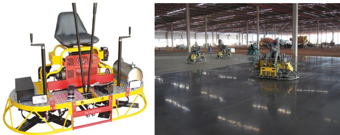
FIGURAS 13 e 14 – MÁQUINAS ACABADORAS DE PISO
