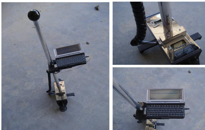
FIGURA 31 – DIPSTICK (EQUIPAMENTO PARA MEDIR O “F” NUMBER)
