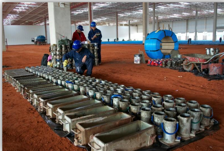
Fig. 54 – Moldagem de CPs cilíndros e prismáticos (Fonte: Fernandes Engenharia 10 )
