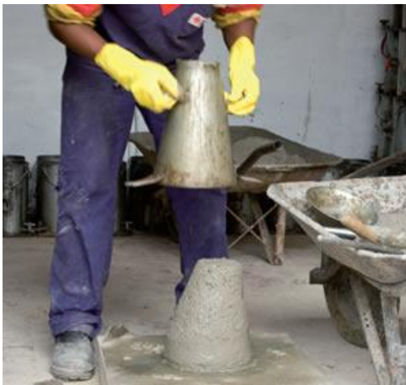
Fig. 51 – Realização do slump test (Fonte: Revista Equipe de Obra 7 )
