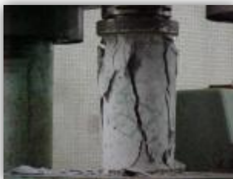
Fix. 52 – Ensaio de compressão com prensa hidráulica (Fonte: UFPE 8 )
