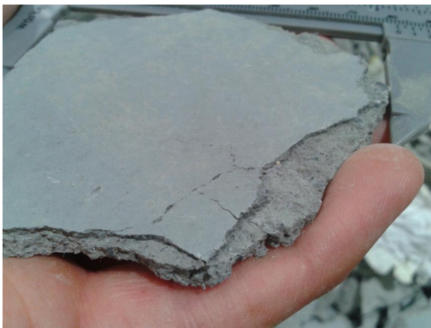
Fig. 83 – Detalhe da separação entre a camada mais superficial e a mais profunda apenas na argamassa (Fonte: Própria)
