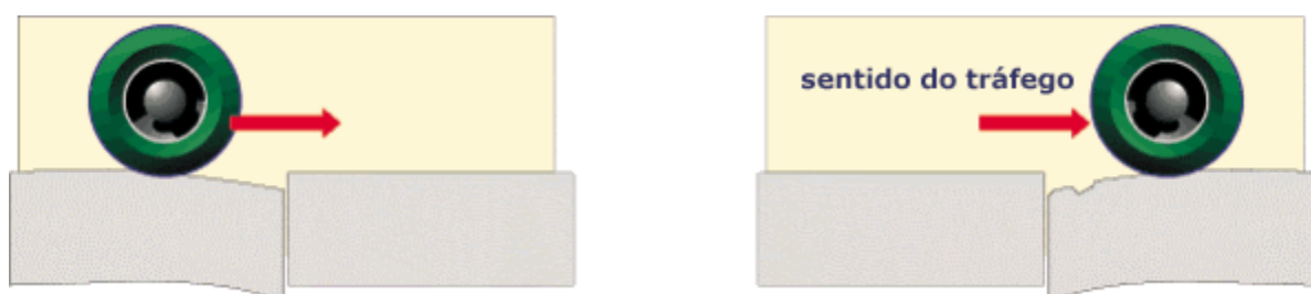
Fig. 20 - Junta sem dispositivo de transferência de carga (Fonte: Portal LM Brasil)
