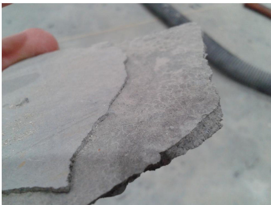
Fig. 80 – Amostra de fragmento delaminado (Fonte: Própria)
