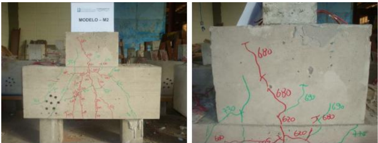
Figura 50: Fissuras no colarinho e bloco de fundação ensaiado Fonte: Barros, 2009.
