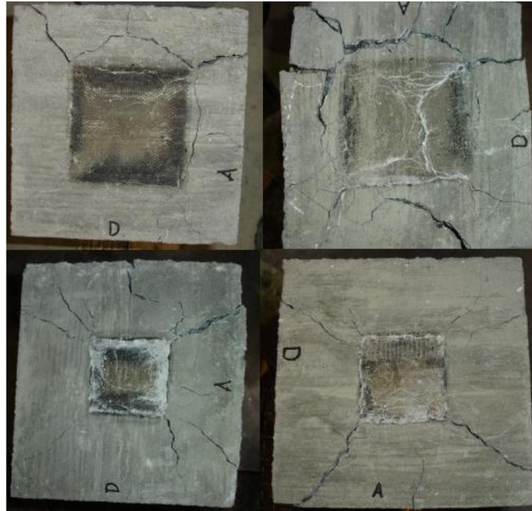
Figura 27: Configuração das fissuras com placas de diferentes dimensões Fonte: Axson, 2008.
