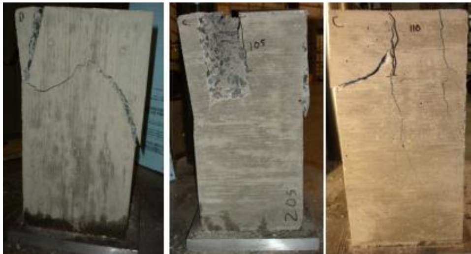
Figura 26: Configurações das fissuras nos prismas reforçados com estribo helicoidal Fonte: Axson, 2008.
