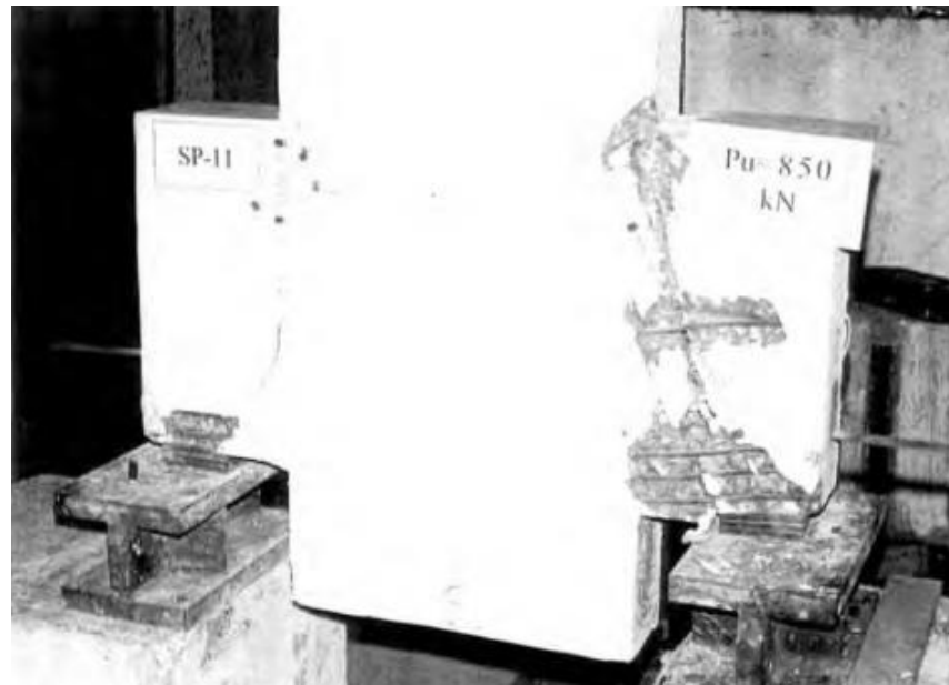
Figura 42: Ensaio de ruptura com escoamento da armadura de costura. Fonte: Naegeli, 1997.
