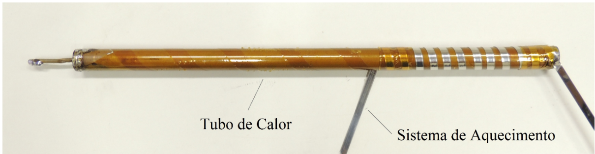
Fotografia 10 - Tubo de calor com sistema de aquecimento Fonte: Autoria própria.
