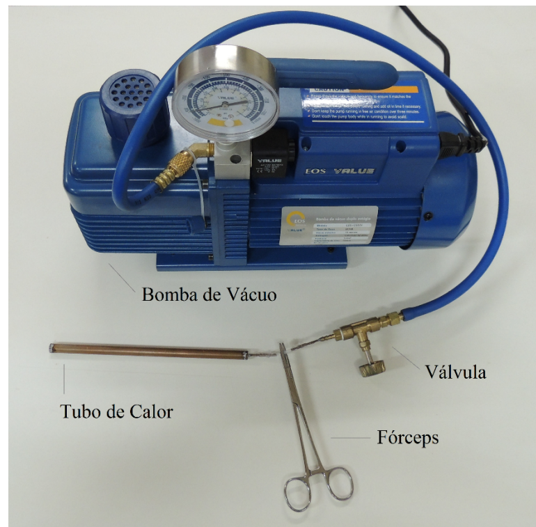
Fotografia 6 - Bomba de vácuo e tubo de calor Fonte: Autoria própria.
