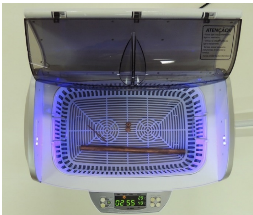
Fotografia 3 - Banho ultrassônico utilizado na limpeza do tubo de calor e seus componentes Fonte: Autoria própria.
