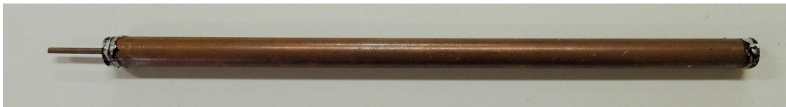
Fotografia 5 - Tubo de cobre após a soldagem Fonte: Autoria própria.
