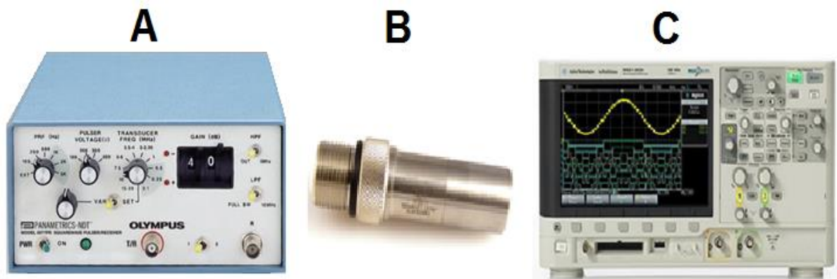
Figura 24 - (A) Equipamento de Ultrassom Olympus modelo 5077PR; (B) Transdutor Olympus modelo V 327/10 MHz; (C) Osciloscópio Infinii Vision modelo DSO-X 2022 a .
