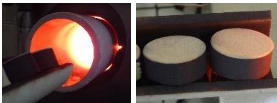
Figura 26 – Amostras durante a etapa de resfriamento entre um ciclo e outro de oxidação.
