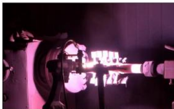
Figura 8. Exemplo da deposição do revestimento top coat por APS.
