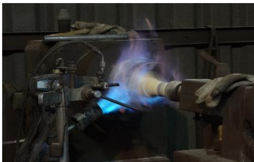
Figura 14 – Pré-aquecimento do revestimento Bond Coat com uso de maçarico.
