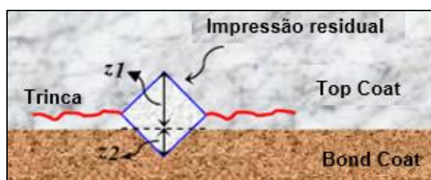
Figura 19 – Exemplo da indentação com formação de trincas. Fonte: Adaptado de Mao et al. (2012).
