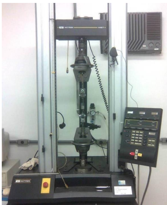
Figura 17 – Equipamento de ensaio de tração a ser utilizado nos ensaios de aderência.
