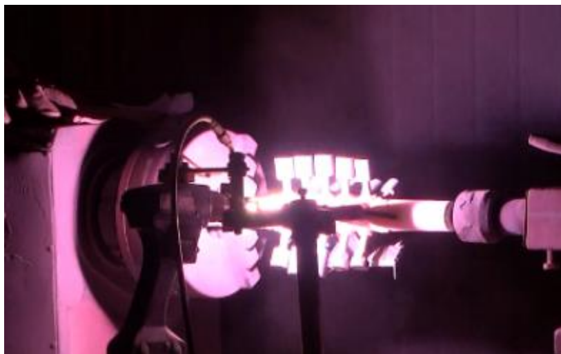
Figura 15 – Exemplo da deposição do revestimento Top Coat .
