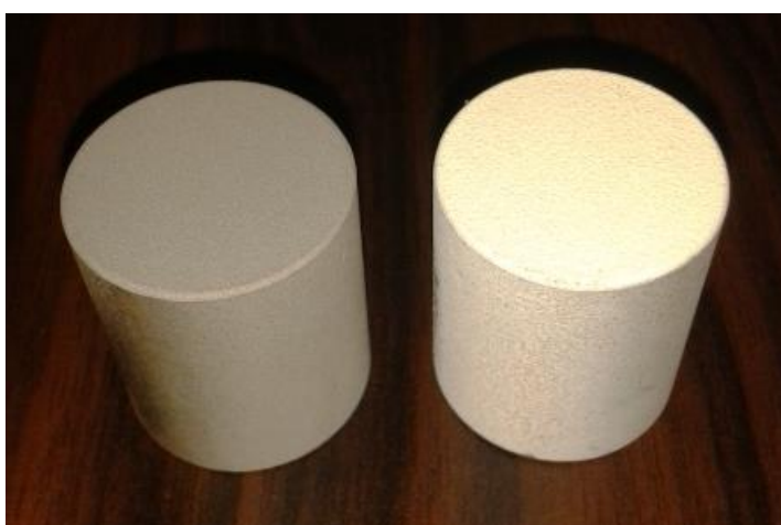
Figura 21 – Exemplo das amostras depositadas por HVOF (à esquerda) e APS (à direita).
