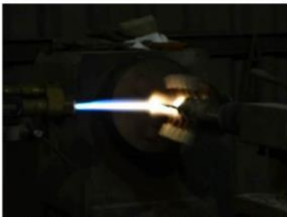
Figura 6. Exemplo da deposição do revestimento bond coat por HVOF.
