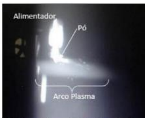
Figura 9. Monitoramento da aspersão térmica APS com Spray View.
