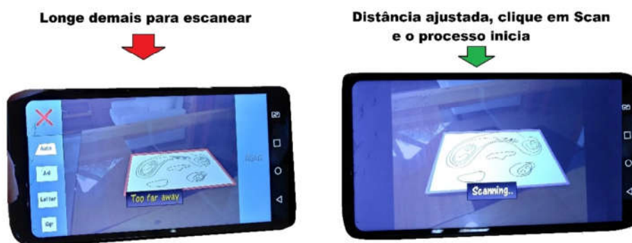
Figura 1- Escaneamento das curvas de nível pelo sistema operacional do aplicativo LandscapAR
