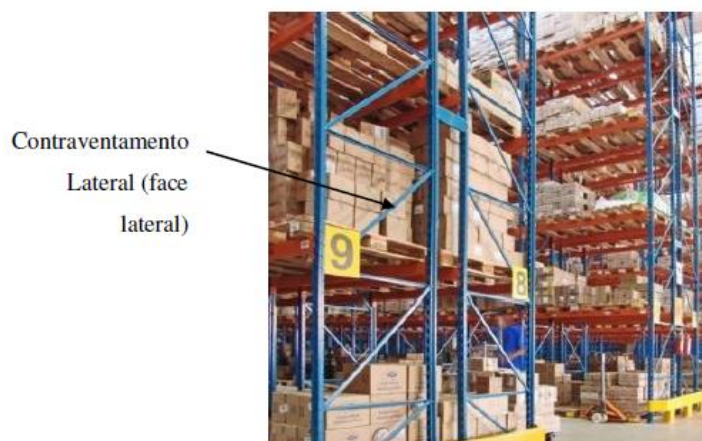
Figura 16 – Travessas e diagonais do sistema Porta Pallets Fonte: Águia Sistemas (2015)
