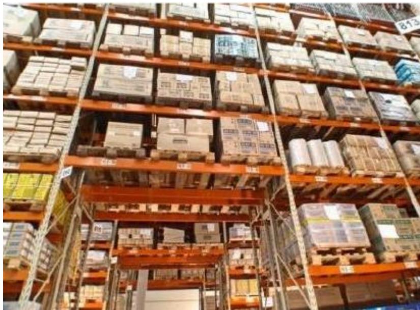
Figura 13 - Sistema Porta Pallets carregado com três ou dois pallets por viga Fonte: Água Sistemas (2015)
