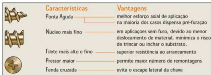
Figura 17 - Características parafuso autoatarrachante
