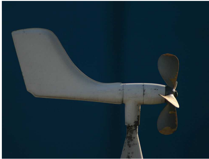
Figura 4: Anemômetro de pás e hélices: A velocidade que o equipamento mede está relacionada com a frequência de rotação das hélices.
