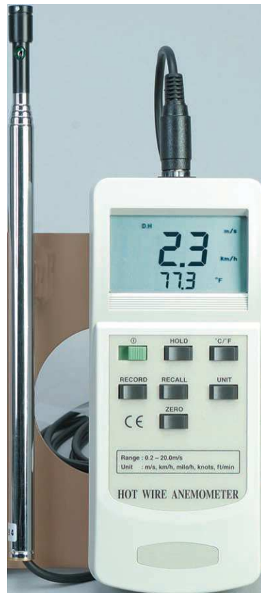
Figura 5: Anemômetro de fio quente: A velocidade que o equipamento mede está condicionada a variação de energia a ser fornecida ao fio quente para mantê-lo em temperatura constante.
