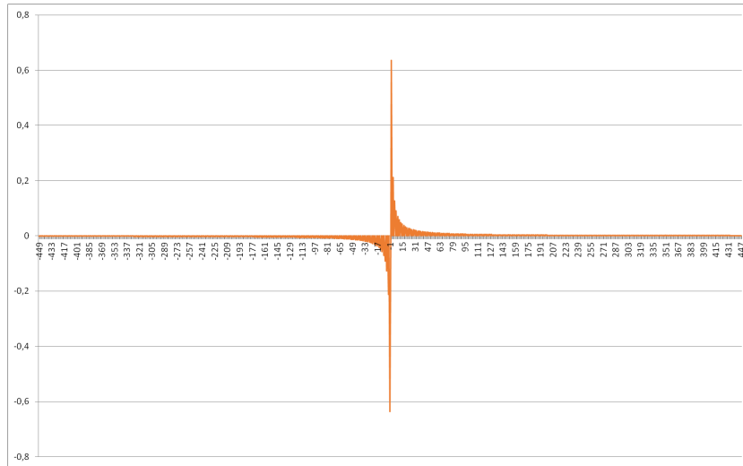
Figura 59: Gráfico da resposta ao impulso da função da transformada de Hilbert conforme equação 96.
