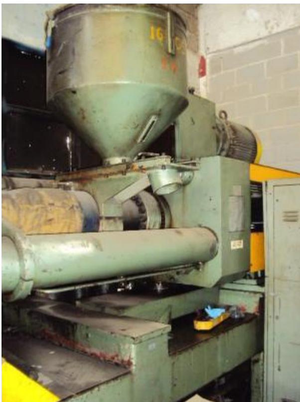
Figura 7 - INJETORA BATTENFELD BSKM 3200_500S, Ano 1980 Fonte: Site superbid.net – leilões
