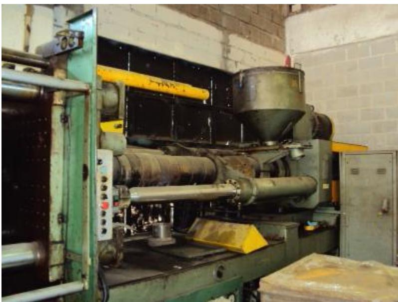
Figura 6 - INJETORA BATTENFELD BSKM 3200_500S, Ano 1980 Fonte: Site superbid.net - leilões
