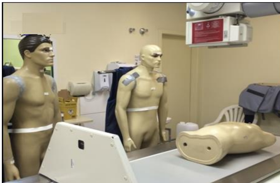
Figura 13 – Foto da medida de dosimetria ocupacional com a mesa na posição horizontal.
