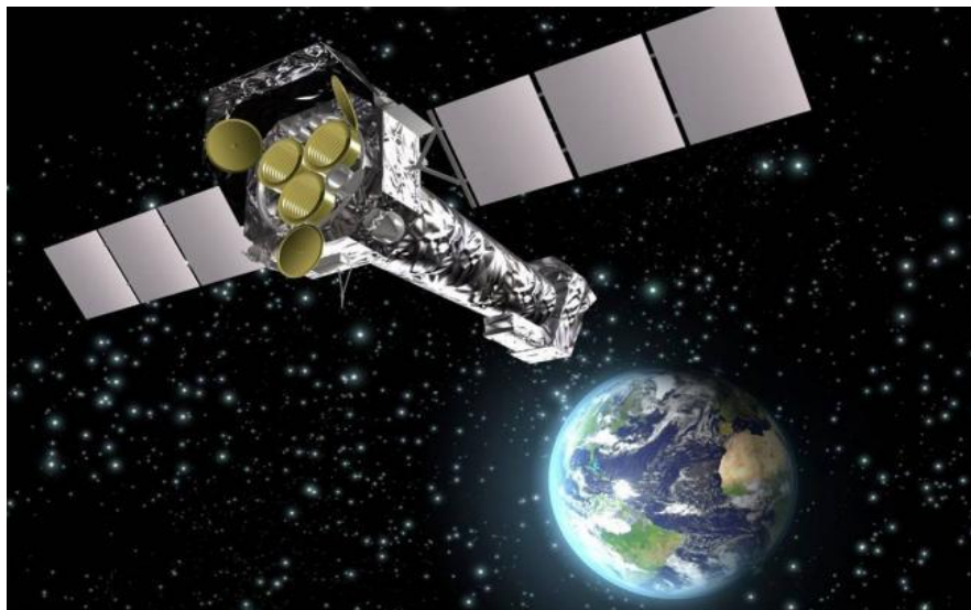
Figura P. Chandra X-Ray Observatory. Foi lançado em julho de 1999 pela missão STS-93 do ônibus espacial Columbia. É o terceiro dos quatro grandes da NASA. Ele pode observar o céu em raios-x com uma resolução angular de 0,5 segundos de arco, mil vezes mais acurado que o primeiro telescópio orbital de raios-x. Crédito imagem: NASA . (disponível em: http://coolcosmos.ipac.caltech.edu/cosmic_classroom/cosmic_reference/great_obs.html )
