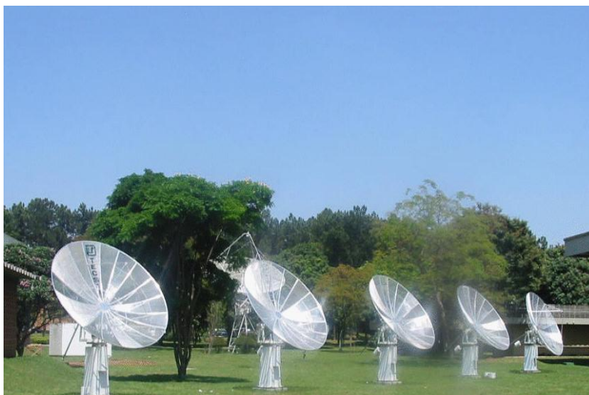
Figura B. Brazilian Decimetric Array, INPE. Esse radiotelescópio tem 38 antenas de 5 metros de diâmetro dispostas em forma "T". Opera nas faixas de frequência f : 1,2-1,7 GHz, 2,7 e 5,0 GHz. Crédito imagem: INPE. (disponível em: http://www.das.inpe.br/fmi/MainBDA.html ).
