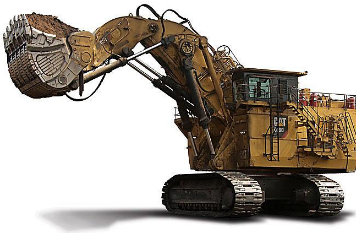
Figura 6 - Escavadeira Tipo "shovel" Fonte: Caterpillar (2015)
