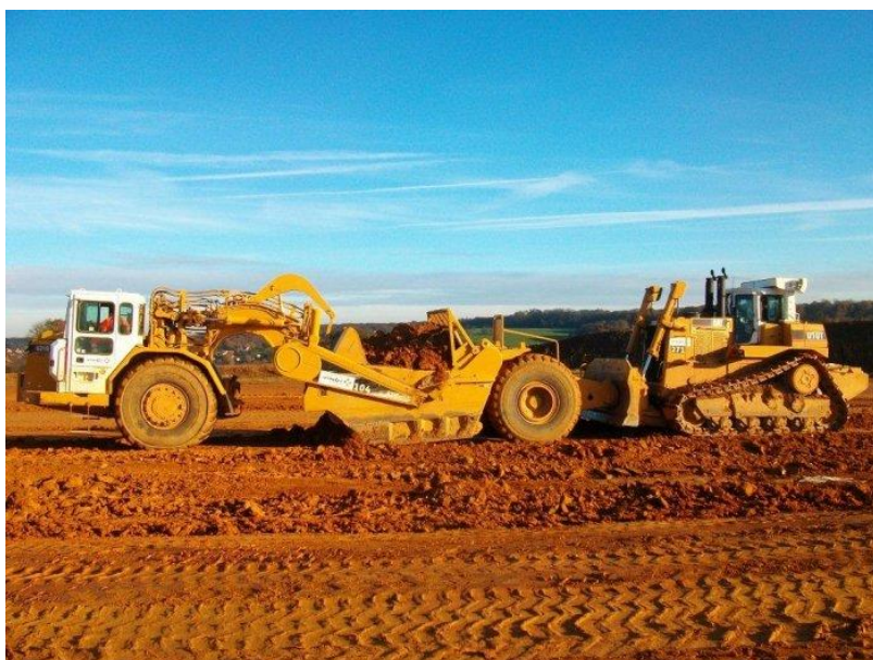
Figura 2 - Motoscraper recebendo o push Fonte: Página do sítio The Construction, 2015
