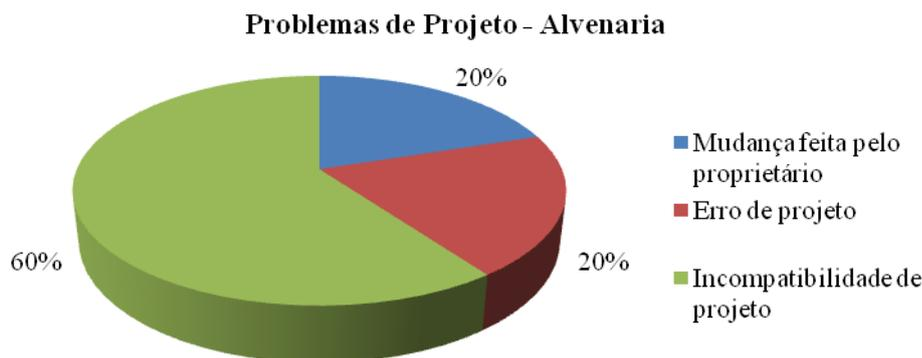
Figura 4.3: Gráfico de problemas de projeto referentes à fase de alvenaria, classificados por tipo de interferência.
