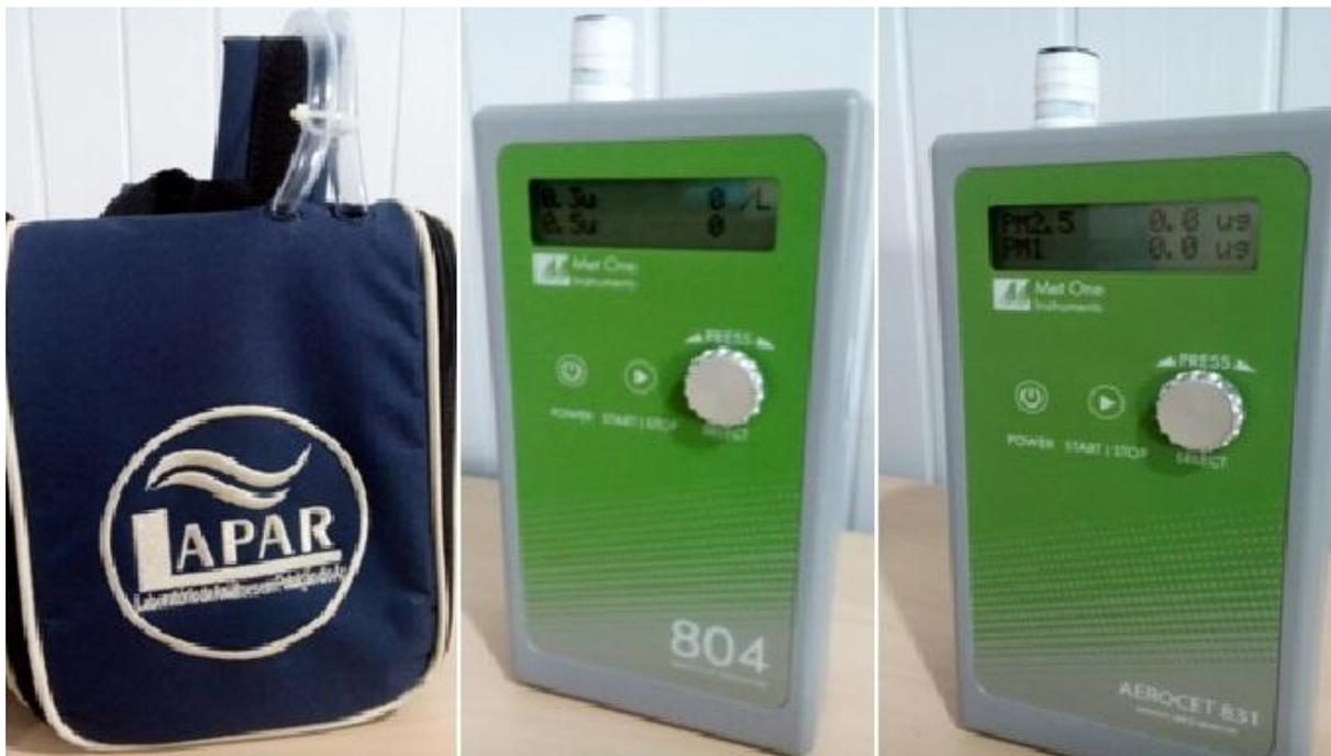
Figura 4: Mochila e os equipamentos utilizados na amostragem pessoal de material particulado.
