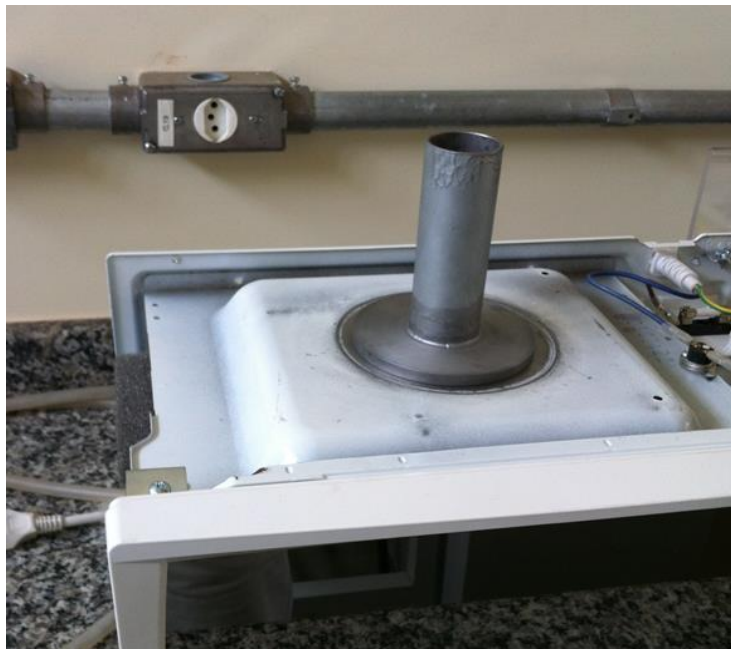
Figura 13 - Fotografia do adaptador na cavidade interna do forno micro-ondas Fonte: Autoria própria.
