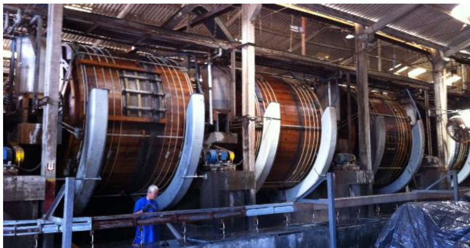
Figura 2 - Fotografia de bateira de fulões em curtume Fonte: Autoria própria.
