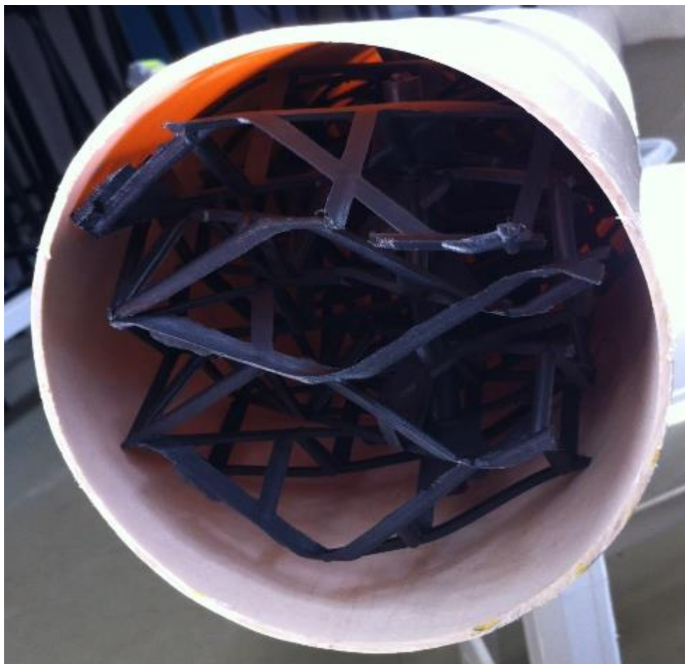
Figura 20 - Fotografia da torre de arraste da amônia com recheio grade de enchimento (GE) Fonte: Autoria própria.
