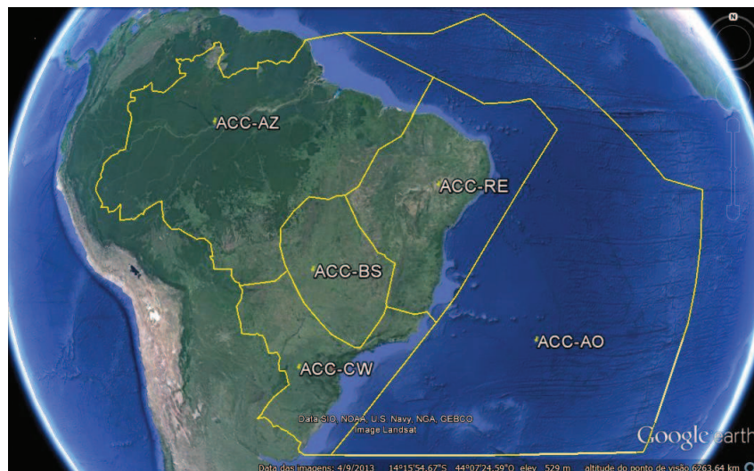
Figura 3: Disposição das regiões de responsabilidade de tráfego aéreo dos 5 ACC existentes no Brasil.
