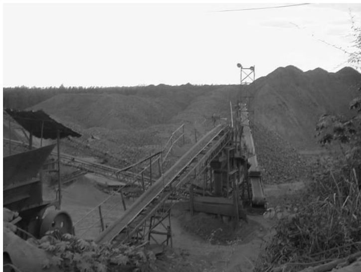
Figura 2 - Pátio para estocagem de escória de alto-forno FONTE: SOUZA JÚNIOR, 2007.
