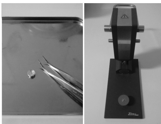
Figura 33 - Porta amostra com o furo e mini prensa para fechamento hermético
