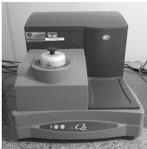
Figura 32 - Equipamento para análise térmica (DSC)
