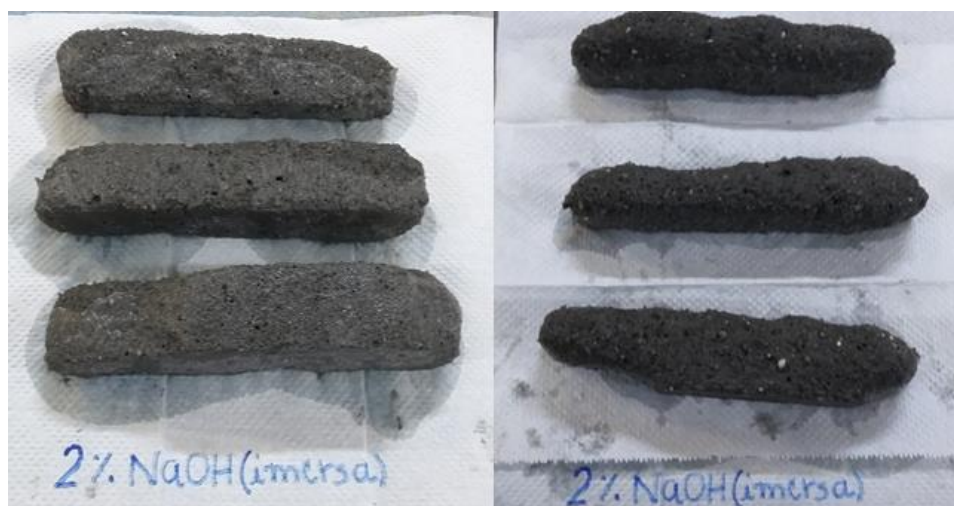
Figura 36 - Argamassas ativadas com 2%NaOH (cura imersa) 28 dias
