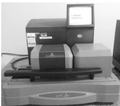
Figura 31 – Equipamento para análise térmica (TG/DTG)
