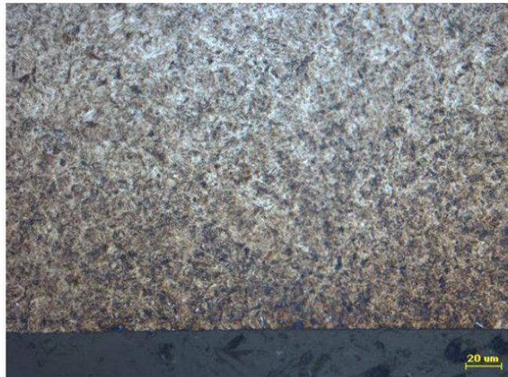
Figura 55 - Análise metalográfica na terceira parte da sede (ampliação de 500x, ataque com Nital 2%) de um corpo retificado sem o defeito recorrente
