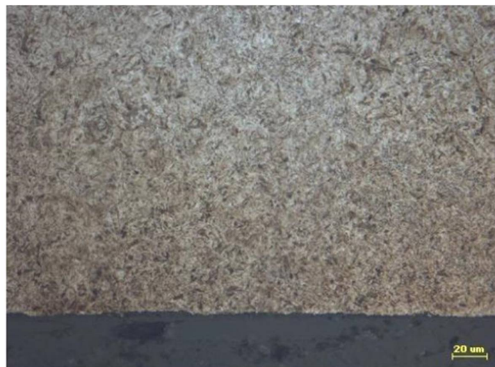
Figura 56 - Análise metalográfica na terceira parte da sede (ampliação de 500x, ataque com Nital 2%) de um corpo retificado com o defeito recorrente
