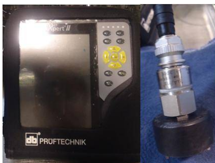
Figura 48 – Equipamento do fabricante Prüftechnik , modelo VIBXpert II utilizado no ensaio adicional de vibrações
