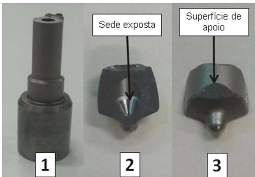
Figura 39 - Amostra preparada para medição no interferômetro: 1- Restante da amostra após corte, 2- Corte em detalhe para deixar sede exposta e 3- Superfície oposta retificada para apoio Fonte: Autoria própria
