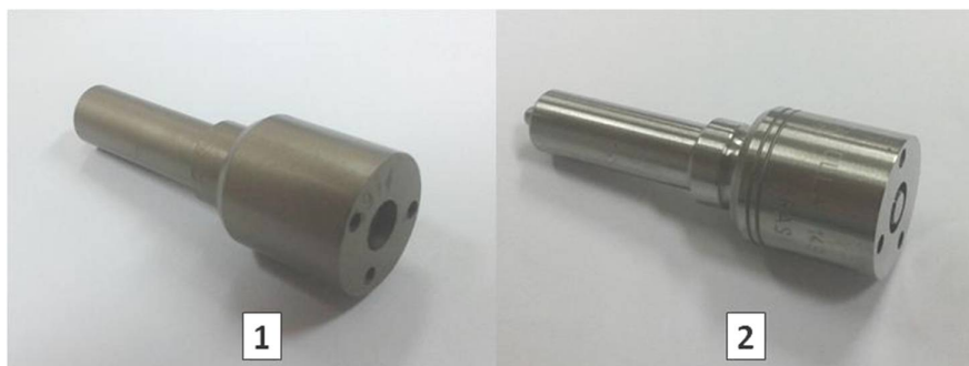
Figura 20 - Corpo (1) e bico injetor (2) Diesel geração EURO5 Fonte: Empresa parceira deste projeto
