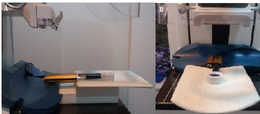
Figura 35 - Disposição da câmara de ionização posicionada nas alturas. A) vista lateral; B) vista de frente.
