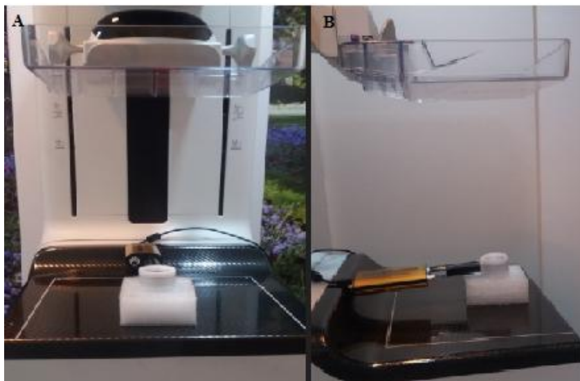
Figura 32 - Posicionamento da câmara de ionização para o teste de CSR. A) Vista de frente; B) Vista lateral.
