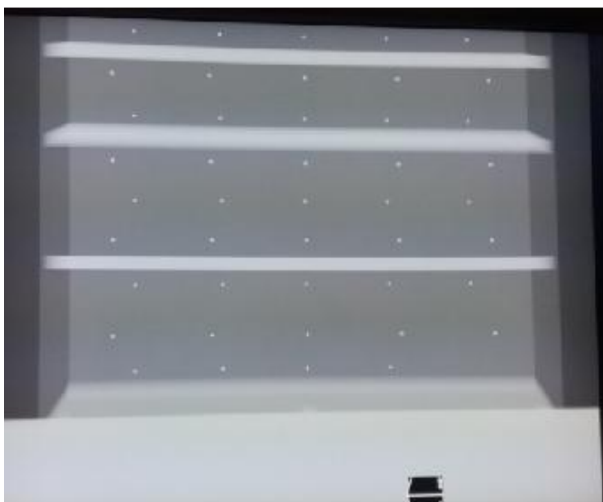
Figura 40- Imagem exposta do teste de Calibração de Geometria, mostrando as esferas de Al.
