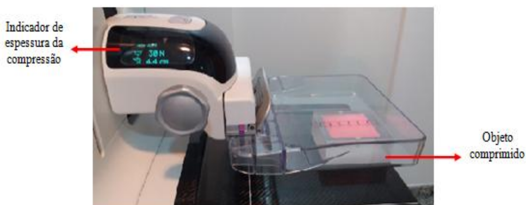
Figura 25 - Simulador de mama ACR posicionado e comprimido para comparar a espessura com a demonstrada no display do compressor.
