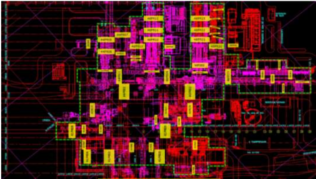
Figura 2: Leiaute das principais pontes rolantes da Aciaria e Lingotamentos
