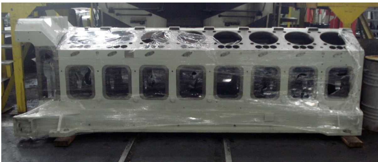
Figura 10 - Bloco do motor diesel Fonte: Autoria própria
