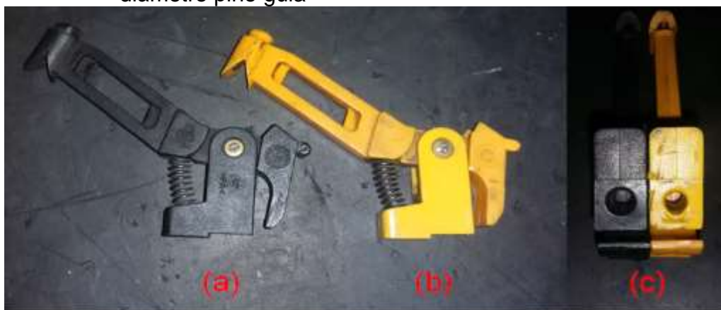
Figura 2.3 – (a) Pantógrafo 380 V, 24V; (b) Pantógrafo terra; (c) diferença diâmetro pino guia
