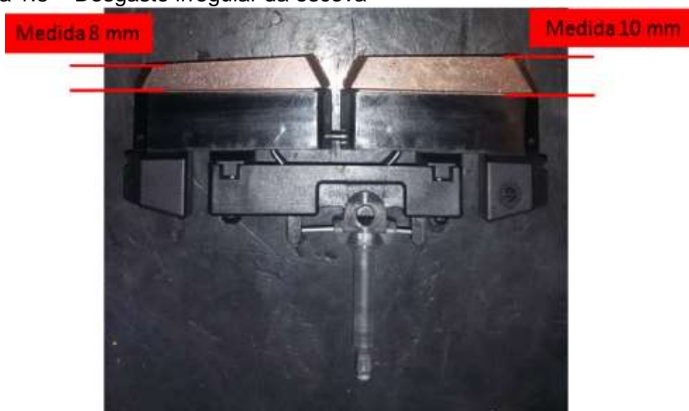
Figura 1.5 – Desgaste irregular da escova
