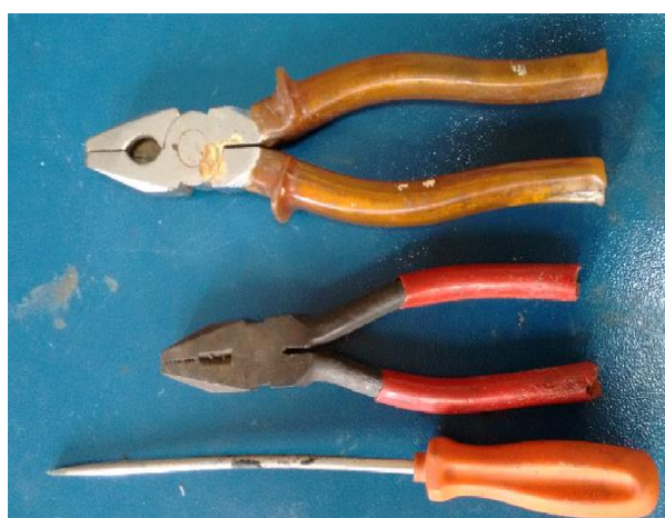
Figura 6 - Ferramentas incorretas adquiridas pelos manutentores. Fonte: Autoria própria.
