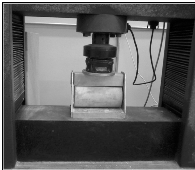
Figura 13 – Ensaio de tração por compressão diametral
