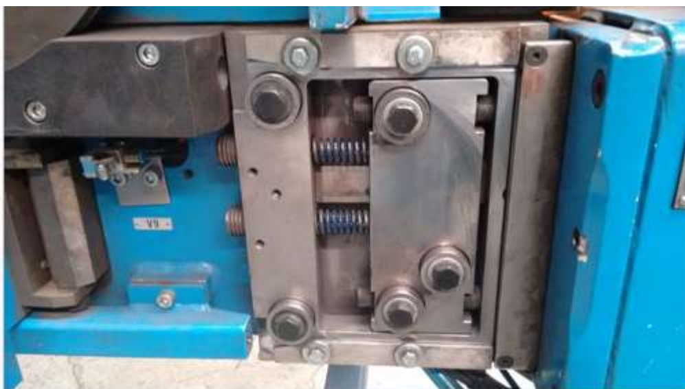
Figura 9 – Foto do mecanismo de controle de tensão do arame Fonte: Empresa
