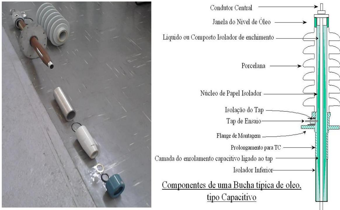
**FIGURA 2.5 – COMPONENTES INTERNOS DE UMA BUCHA CAPACITIVA.**
