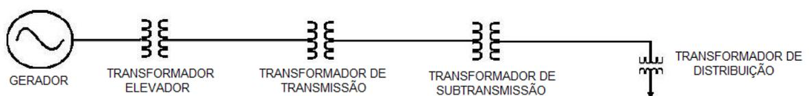
**FIGURA 2.1 – TRANSFORMADORES NO SISTEMA ELÉTRICO.**
