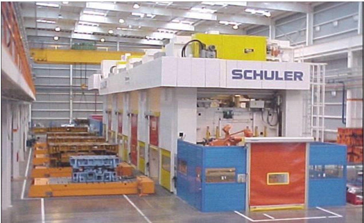
Figura 2.1 – Linha de prensas para estampagem de peças automotivas. Fonte: Autoria própria.
