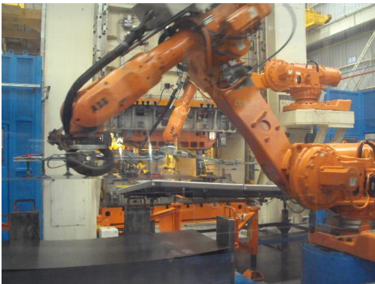
Figura 2.5 – Robô retirando a chapa do fardo de matéria prima. Fonte: Autoria própria.
