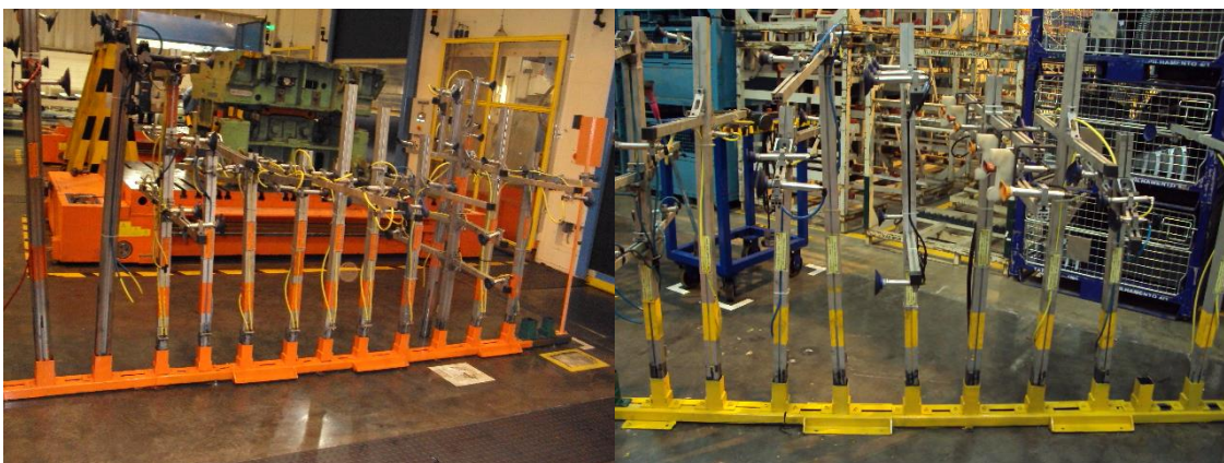
Figura 4.11 – Alojamento de garras após aplicação da MCC. Fonte: Autoria própria.
