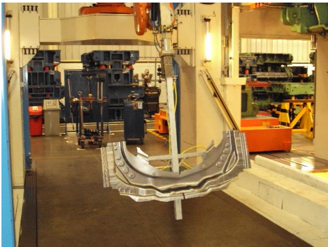
Figura 2.6 – Garra pneumática sustentando uma peça. Fonte: Autoria própria.
