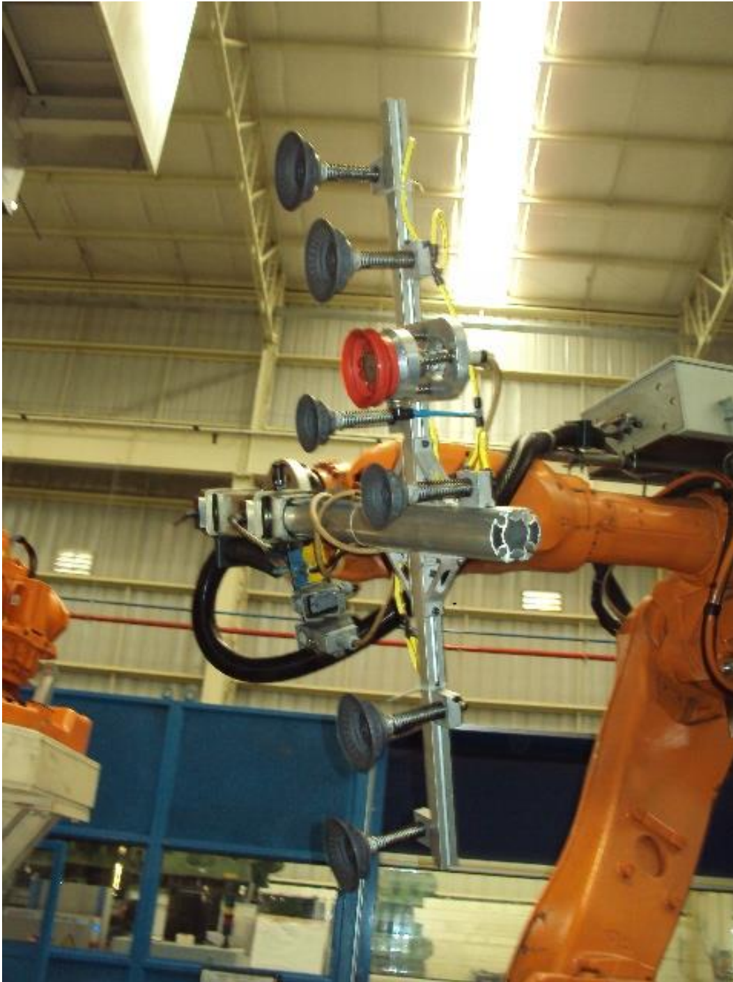
Figura 2.2 – Garra pneumática instalada no robô. Fonte: Autoria própria.
