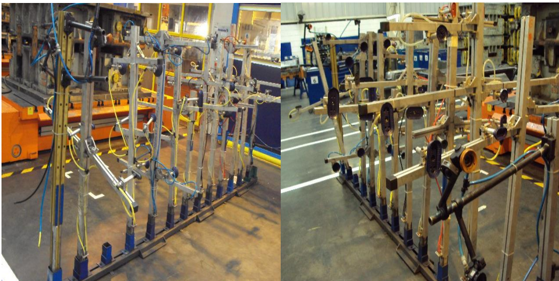
Figura 4.10 – Alojamento de garras antes da aplicação da MCC. Fonte: Autoria própria.
