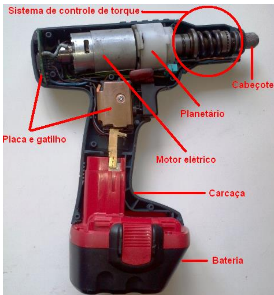
Figura 11 - Conjuntos principais de uma aparafusadeira Fonte: Autoria própria
