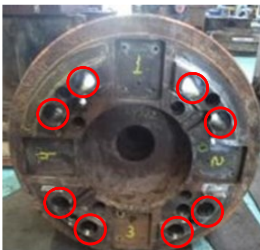
Figura 27- Imagem cabeçote do mandril conforme projeto original
