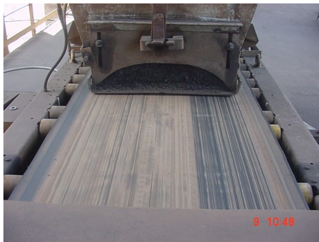
Figura 2.10 – Correia de balança dosadora
