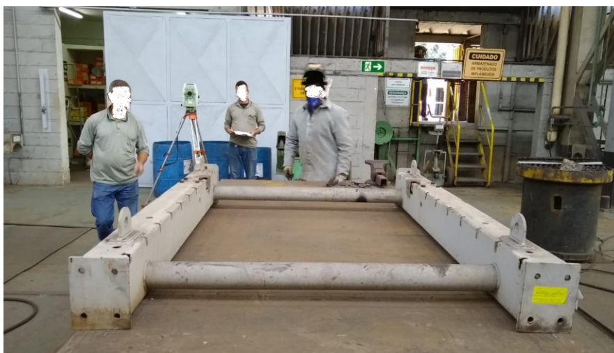
Figura 2.7 – Estrutura mecânica de uma balança dosadora
