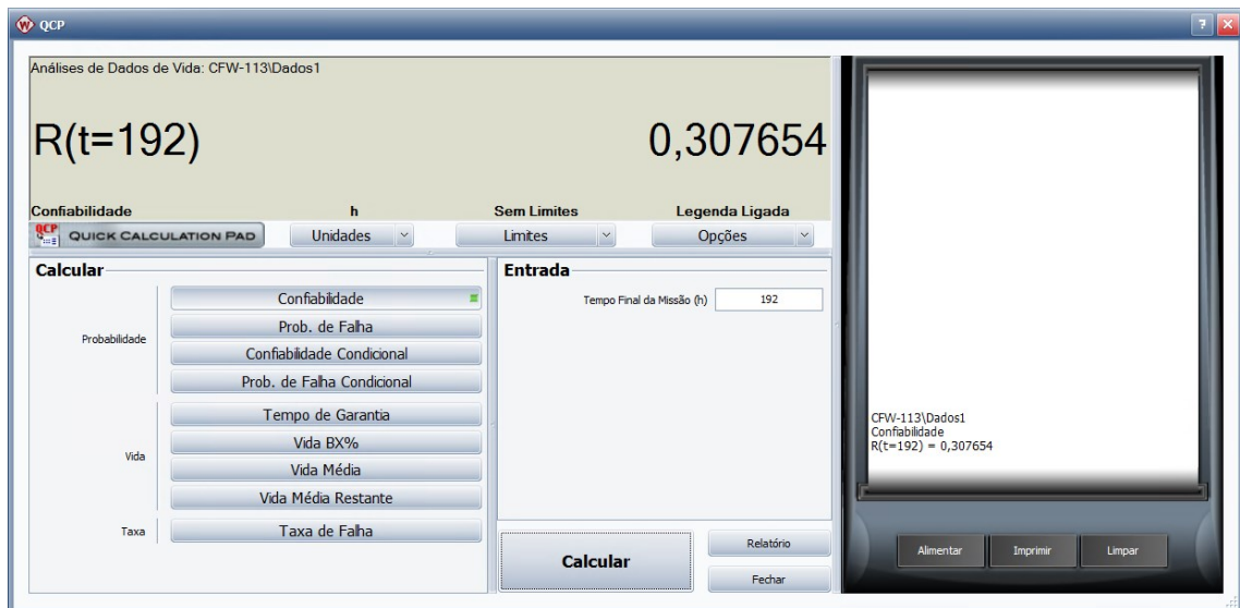
Figura 4.13 – Cálculo da confiabilidade da balança dosadora CFW-113
