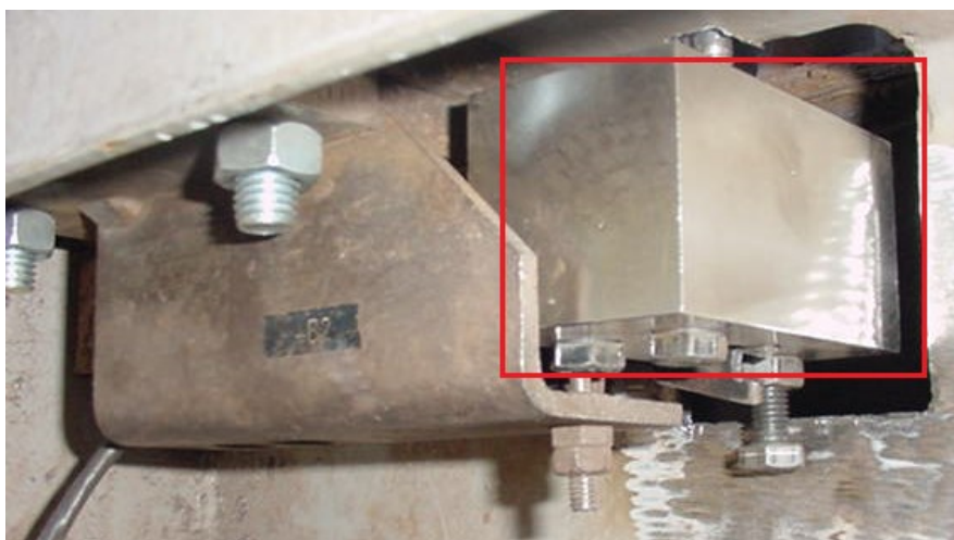
Figura 2.4 – Célula de carga
