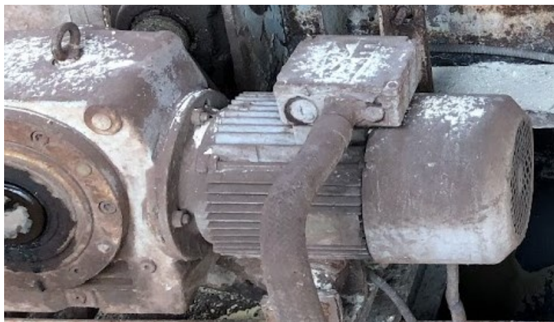
Figura 2.2 – Motor de uma balança dosadora
