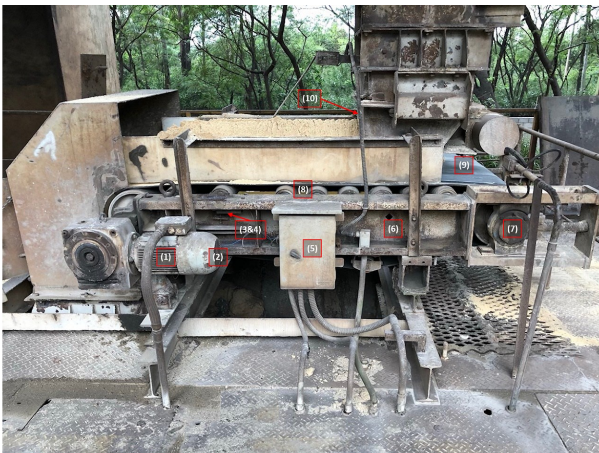
Figura 2.1 – Balança dosadora (principais componentes de campo)
