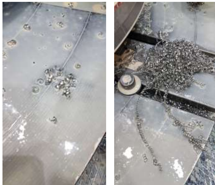
Figura 18 – Alteração no cavaco devido a falha da ferramenta
