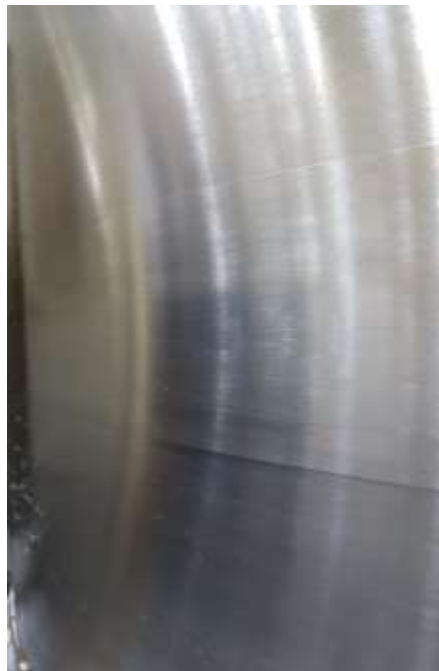
Figura 16 – Alteração da superfície com mudança súbita de acabamento devido a falha da ferramenta
