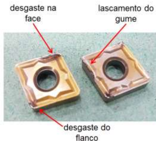
Figura 15 – Insertos com diferentes formas de falha
