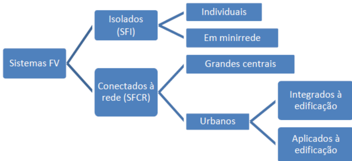
Figura 2: Tipos de sistemas fotovoltaicos
