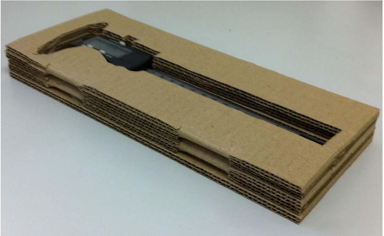
**Figura 22 – Calço CFG com o paquímetro acondicionado.**
