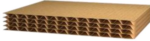
**Figura 6 – Imagem papelão ondulado parede múltipla.**
