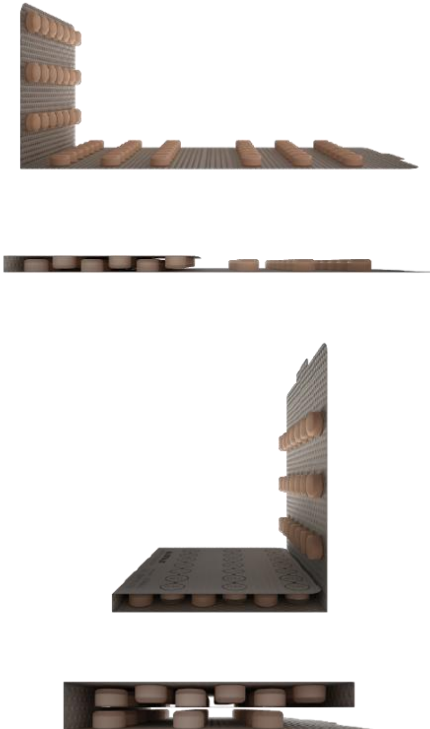
Figura 15 – Sistema de dobras do Blister Fonte: Autor (2013)
