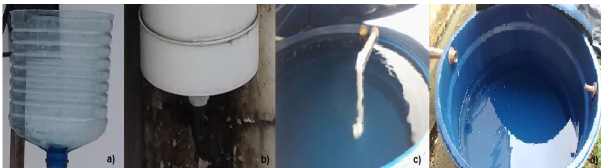
Figura 27: Pontos de amostragem do sistema de tratamento de água da chuva – a) Ponto de coleta da amostra da chuva in natura ; b) Ponto de coleta da amostra de água do first-flush ; c) Ponto de coleta da amostra da água da chuva bruta; d) Ponto de coleta da amostra da água da chuva após tratamento.
