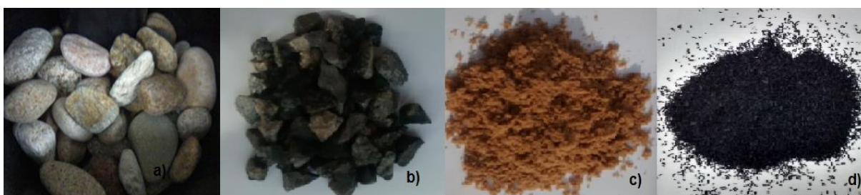
Figura 19: Materiais filtrantes utilizados na construção do filtro ascendente – a) Seixo rolado; b) Brita; c) Areia; d) Carvão ativado granular.
