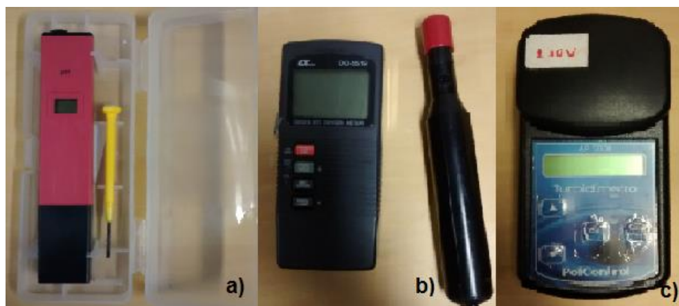
Figura 31: Equipamentos utilizados para a leitura de pH, oxigênio dissolvido e turbidez – a) pHmetro portátil pH 1700; b) Oxímetro Lutron DO 5519; c) Turbidímetro Policontrol AP 2000.
